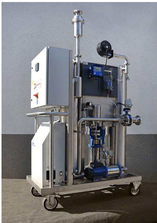
Rys. 2 Mobilny system dezynfekcji ozonem SPID - WOFIL
