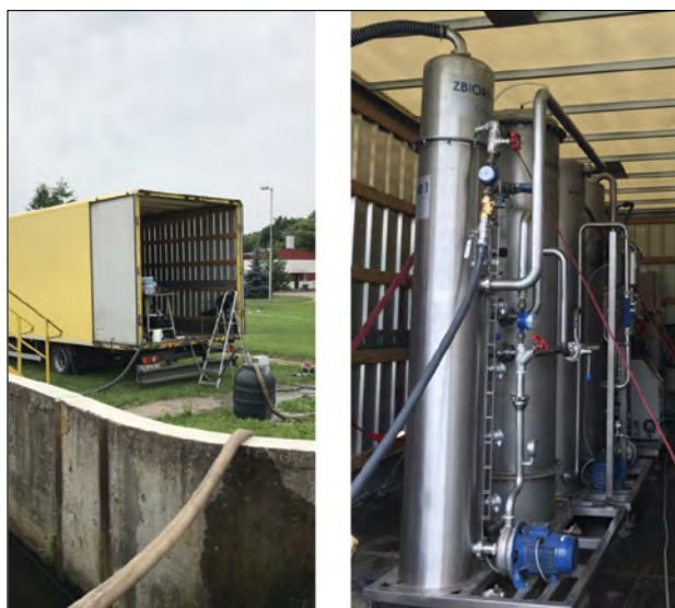
Rys. 4.2 a) Sposób podłączenia i lokalizacja stacji pilotowej b) Stacja badawcza do usuwania farmaceutyków ze ścieków znajdująca się w samochodzie ciężarowym
